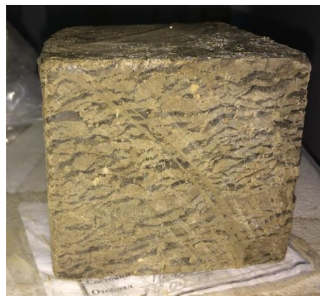
Рис.5 Образец мерзлого природного суглинка со шлировой льдистостью 55%
